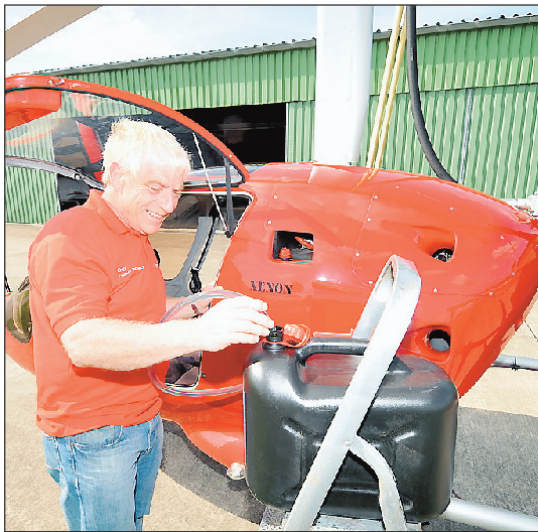
Der 100-PS-Rotaxmotor, der den „Xenon2“ antreibt, gibt sich mit normalem Autobenzin zu frieden.
